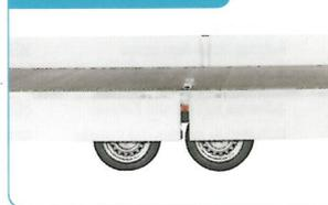
**Klappbare und abnehmbare Bordwände.**
